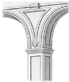
Spandrel: espacio de forma aproximadamente triangular resultante de la superposición de un domo sobre una estructura de arcos. No cumple ninguna función dentro del conjunto, sino que es un subproducto de necesidades estructurales.
